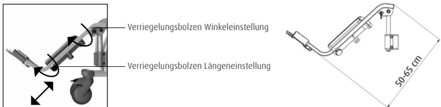
Abbildung 9 Verriegelungsbolzen.
