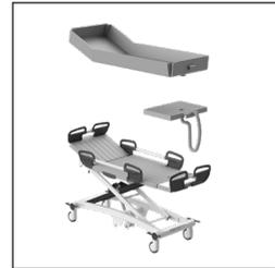
Abbildung 20 Demontage der Grundplatte und der Matratze.
