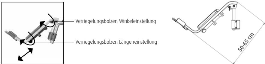
Abbildung 9 Verriegelungsbolzen.
